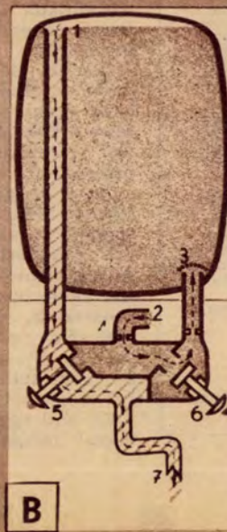
A kép — Megtöltés. B kép — Forró víz kivétel. C kép — Kevert víz kivétel. 1 — túlfolyócső, 2 — vízvezeték-csatlakozás, 3 — hideg víz beömlés, 4 — fojtó tárcsa, 5 — hideg víz szelep, 6 — forró víz szelep, 7 — lengő karos kiömlés
